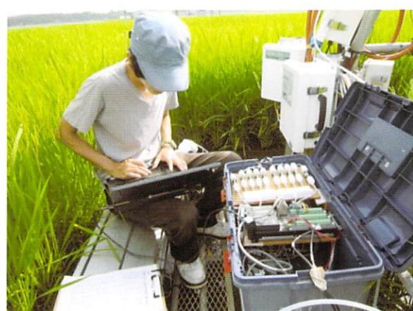
水田による汚染ガス吸収量の測定
